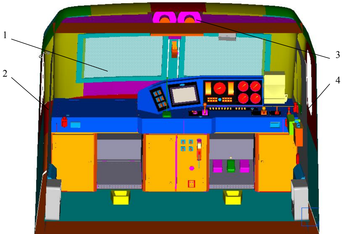
Рис.2.2.17 Расположение остального оборудования в кабине машиниста 1- Оборудования на передней стене; 2 - Оборудования на левой стене; 3 - Оборудования на потолке; 4 - Оборудование на правой стене
